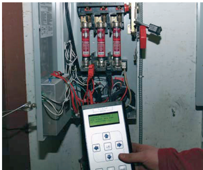
Единичный тест в течение двух минут позволяет оценить состояние обмотки, кабельной разводки и соединений.
