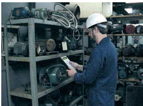
Контроль запасных электрических двигателей предотвращает установку неисправных агрегатов.
