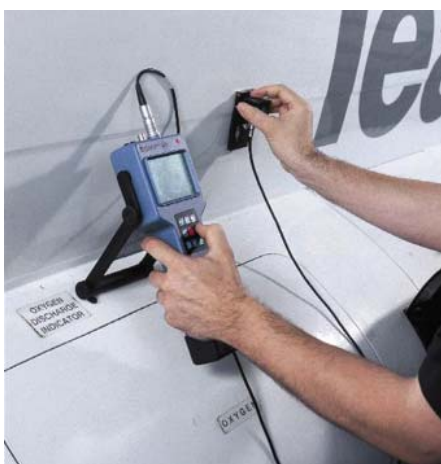
Рис. 6. Примеры применения внутренних роторных датчиков для контроля лопаток и колес (слева) и роторных дисковых накладных датчиков для контроля винтов и обшивки самолетов (справа)
