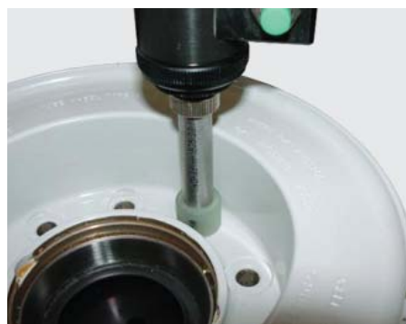
Рис. 6. Примеры применения внутренних роторных датчиков для контроля лопаток и колес (слева) и роторных дисковых накладных датчиков для контроля винтов и обшивки самолетов (справа)
