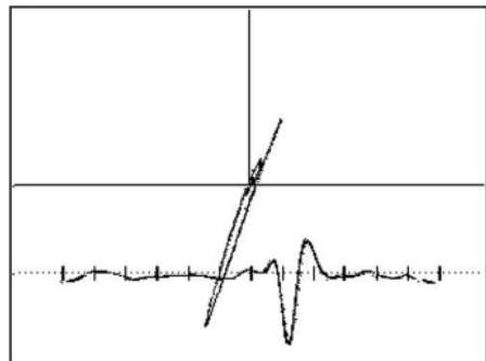
Рис. 7. Сигнал от естественной трещины в крепежном отверстии опоры крепления подкосов самолета Ту 154 ( f = 550 кГц, полное усиление 28,5 дБ, дифференциальный вращающийся датчик)
